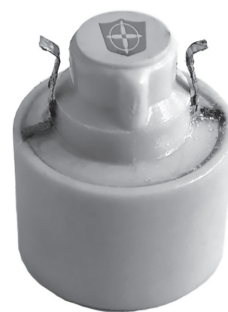
Рис. 5. Внешний вид поверхности корпуса источника тока, изготовленного из пресс-материала АГ-4В (трещина с протекающим электролитом, образовавшаяся на месте дефекта типа стыка потоков материала).
