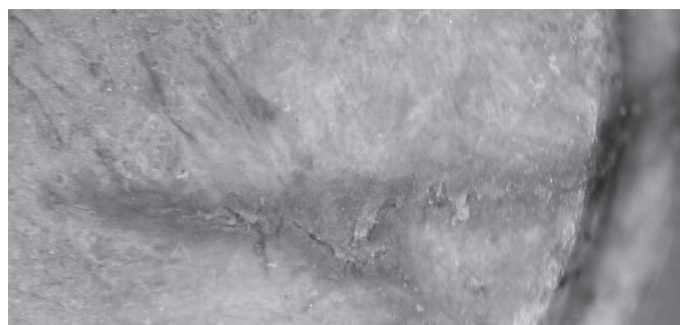
Рис. 5. Внешний вид поверхности корпуса источника тока, изготовленного из пресс-материала АГ-4В (трещина с протекающим электролитом, образовавшаяся на месте дефекта типа стыка потоков материала).
